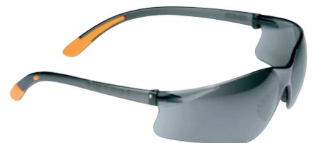
Schutzbrille verspiegelt, Komfortkissen an den Bügelenden, weiche, universell passende Nasenpolster, optisch korrekte einteilige Polycarbonat-Scheibe, kratzfeste Beschichtung. DIN EN 166 Kl.1.
