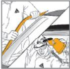
Entfernen der Zierleisten, Rückspiegel, Halterungen und Scheibenwischer nach Angaben des Fahrzeugherstellers.
