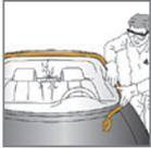
Schutz der Karosseriefächen mit Abdeckband zur Vermeidung von Lackschäden.
