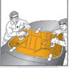
Die neue Scheibe innerhalb der Offenzeit des Klebstoffs einsetzen und positionieren.
