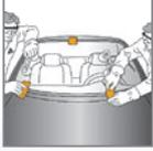
Einpassen der neuen Glasscheibe und korrekte Position der Scheibe mit Klebeband markieren.
