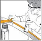
Karosserieflansch mit Scheibenreiniger reinigen.
