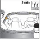
Die Haftfläche mit Sika® Primer-207 primern. Mindestens 3 Minuten ablüften lassen. Bei größeren Schäden muss das betroffene Teil in einer Karosseriewerkstatt repariert werden.
