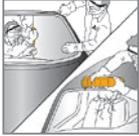
Die beschädigte Glasscheibe mit Vibrationsmesser, Trenndraht, Kaltmesser oder einem vergleichbaren Werkzeug herausschneiden.
