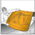
Die beschädigte Glasscheibe entfernen.
