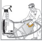
Die neue Scheibe mit Scheibenreiniger reinigen und auf Kontaminationen überprüfen. Falls kontaminiert, mit Sika® PowerClean Aid die Klebefläche reinigen. Mit Papiertuch die Scheibe trocken wischen.
