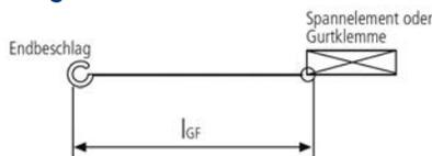
Gemessen vom Tragpunkt des Endbeschlagteiles bis zum äußeren Wenderadius seiner Verbindung mit dem Spannelement.
